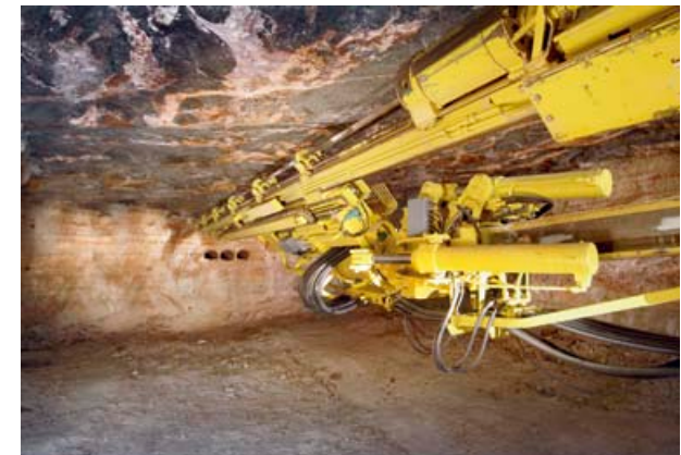
Mit dem Bohrwagen bohrt ein Bergmann Löcher sieben Meter tief ins Gestein, um die anschließende Absprengung des Rohsalzes vorzubereiten. Das Gerät arbeitet mit höchster Präzision, um die Sprenglöcher im gleichen Abstand anzulegen.
